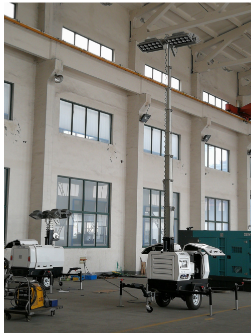
移动照明投射型灯塔
